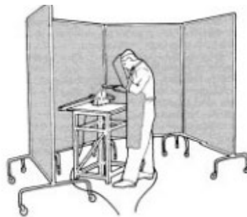
Fig. 4: Mampara de separación
