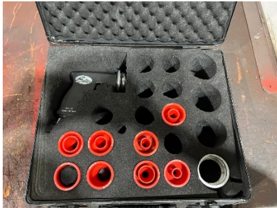
Figura 14. Equipo para limpieza interna de manguera.
